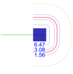
Erforderliche Durchstanzbewehrung je Rundschnitt an Wandende
